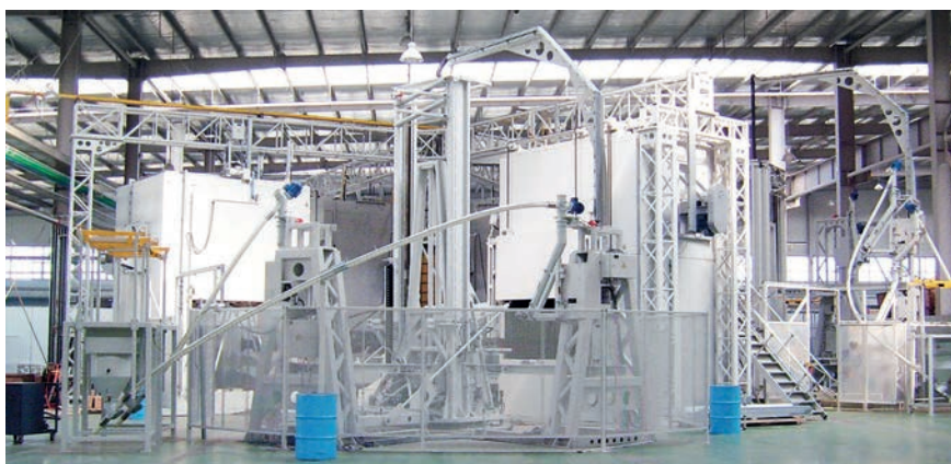
Bild 1. Slush-Molding: In dieser Produktionsanlage werden Slush-Häute für die Pkw-Armaturentafeln hergestellt – ein Beispiel für Kunststoffbauteile, die eindeutig rückverfolgbar sein müssen
